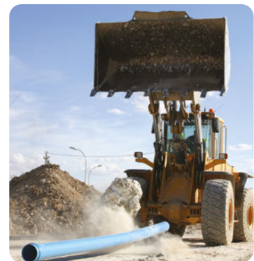
Tras el impacto de una piedra de 500 kg de peso desde una altura de 3 m, la tubería TOM® permanece inalterada.
